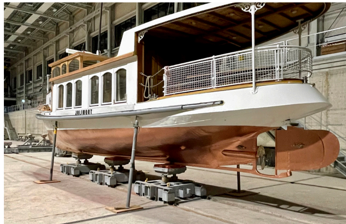
Schalenkontrolle und einen neuen Unterwasseranstrich für das Schiff in der BLS-Werft Thun im Winter 2022/23. Inspection de la coque et nouveau travail de peinture sous-marine du navire au chantier naval BLS Thoune à l'hiver 2022/23. Hull inspection and a new underwater paint job for the ship at the BLS shipyard in Thun in winter 2022/23.
