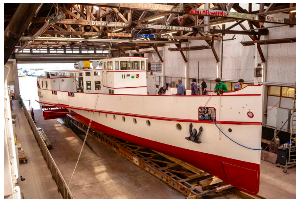
Die „Neuchâtel“ kam im Winter 2023/24 in die Werfthalle der LNM zur Unterwasser-Revision. Le « Neuchâtel » est venu au chantier naval LNM pour une inspection sous-marine à l'hiver 2023/24. The „Neuchâtel“ came to the LNM shipyard for underwater overhaul in winter 2023/24.
